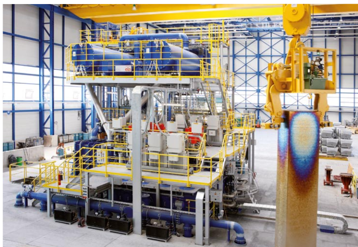
Der neue Elektronenstrahl-Ofen verdoppelt die Gesamtschmelzkapazität von ThyssenKrupp Titanium auf 10.000 t pro Jahr
